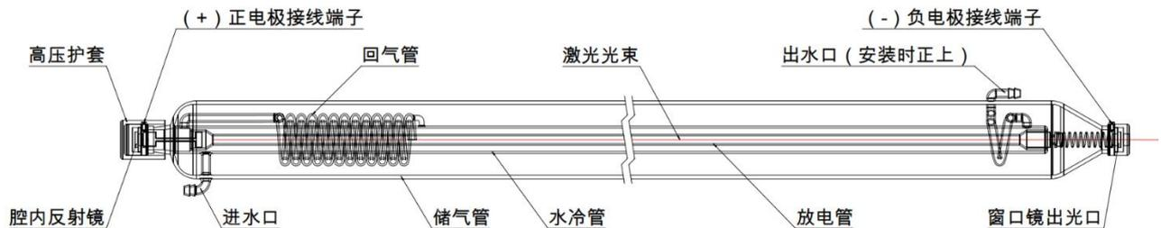
典型的封离式CO<sub>2</sub> 激光管基本结构如上图所示，主要由硬质玻璃、谐振腔、电极三部分组成。
