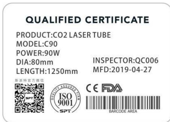
此签指示激光管的编号、型号、长度、管径、功率、检测人员、出厂日期，IS9001 质量管理认证、CE 认证、FDA 认证。
