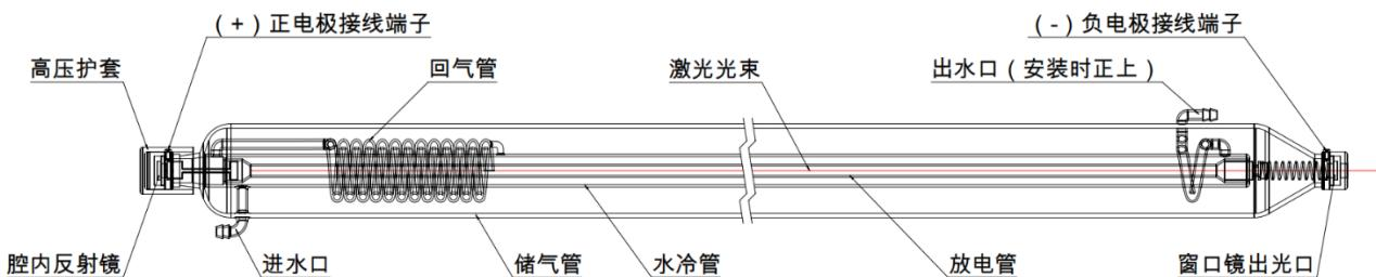
典型的封离式CO<sub>2</sub>激光管基本结构如上图所示，主要由硬质玻璃、谐振腔、电极三部分组成。
